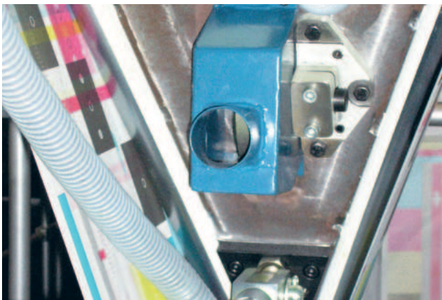
Saughaube am Schneidemesser einer Druckerpresse
